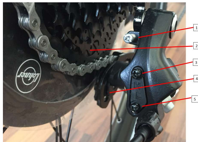
Abbildung 25: Einstellschrauben am Kettenwerfer
