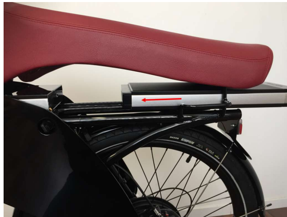
Abbildung 5: Montage des Akkus in Pfeilrichtung
