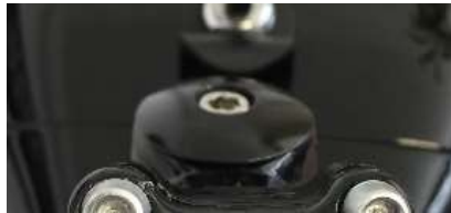
Abbildung 4: Schraube zum Einstellen des Lenklagers
