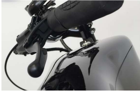
Abbildung 3: Beachten Sie den Abstand zwischen Verkleidungsteil und Bremshebel
