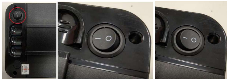
Abbildung 7: Batterieunterseite Links: Hauptschalter Mitte: Batterie EIN Rechts: Batterie AUS
