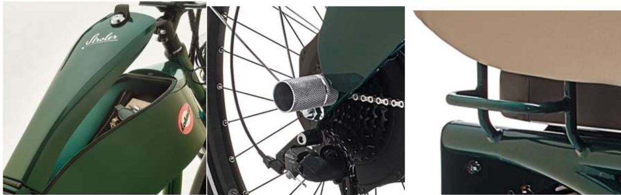
Abbildung 16: Links: Stauraum Mitte: Fußraster Rechts: Haltegriff
