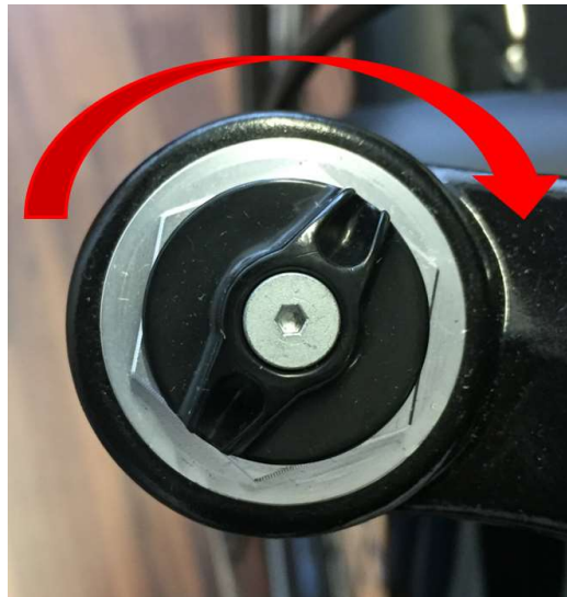
Abbildung 15: Härte der Federgabel – In Pfeilrichtung wird diese straffer
